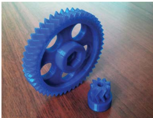
4. ábra. Self-replicating 3D nyomtatott fogaskerék (Forrás: tervezők által létrehozott tartalom)
